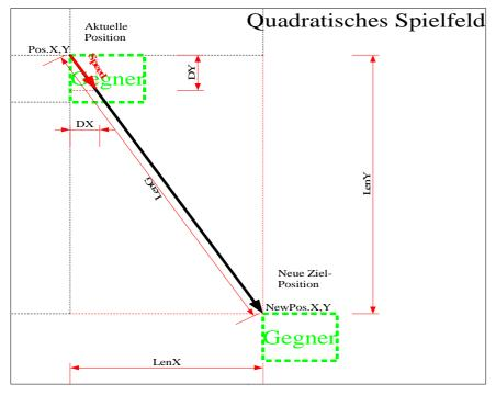
Wie die Berechnung (wie weit der Gegner in X- bzw. Y-Richtung bewegt werden muss) arbeitet, wird anhand der linken Zeichnung erklärt. Der rote Vektor "Speed" gibt die Geschwindigkeit an, um die das Raumschiff bei jedem Schritt zum Ziel hin bewegt wird. Je länger er ist, umso schneller ist das Raumschiff am Ziel. Die benötigten Werte DX und DY können mit Hilfe des Strahlensatzes ermittelt werden:
